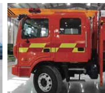
Cấu trúc cabin kép
