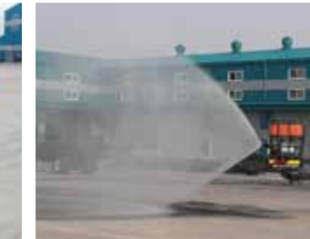
Phun nước tự động (dạng tia thẳng / dạng tia sương)
